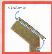
wdmuchiwane pod ciśnieniem włókna celulozy ścielnie wypełniają pozostawione pustki powietrzne
